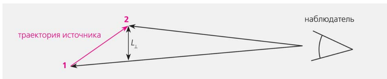
Рис.3. Измерение скорости объекта, движущегося в сторону наблюдателя. Если источник излучения посылает нам световые импульсы из двух последовательных точек 1 и 2 на своем пути в моменты времени t_1 и t_2 , то его истинная скорость движения поперек луча зрения равна v_{\perp} = L_{\perp}/(t_2 - t_1) . Скорость же перемещения видимого на Земле изображения равна отношению L_{\perp} к интервалу времени t'_2 - t'_1 между моментами приема сигналов на Земле: v_{\perp, \text{obs}} = L_{\perp}/(t'_2 - t'_1) . Если источник смещается в сторону Земли почти с той же скоростью, что и свет, то интервал t'_2 - t'_1 оказывается значительно короче, чем интервал t_2 - t_1 . Указанное различие временных интервалов и приводит к кажущейся «сверхсветовой» скорости разлета.
